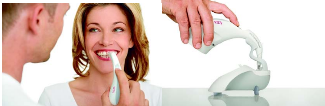
使用前需先對準光學校正瓷塊進行校正
